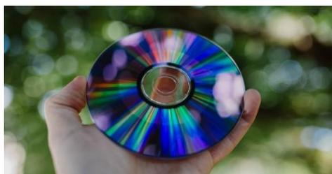
光学ドライブ装置を使い、光の反射によるデータの読み書きを行う記録メディアは光学ディスクや光ディスクと呼ばれています。
